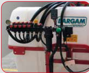
IT Distributore con ON/OFF elettrico e quadro comando
