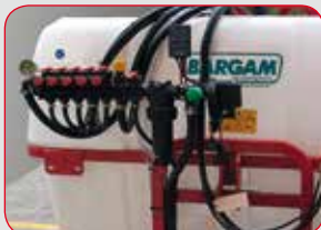
IT Distributore con ON/OFF elettrico e quadro comando
